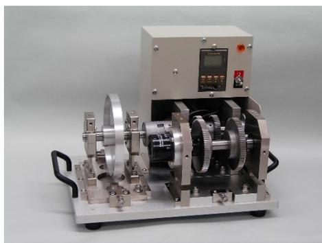
図 V-6 回転機械故障シミュレータ「ミニマスタ」
