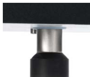
本体下部の5つのハンマヘッドが、交互に床を叩いて衝撃音を発生させます。
