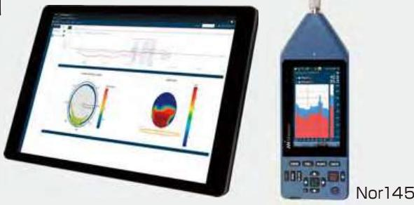
NorCloudでは、NorCloud上で作成した一つのプロジェクトに、4G、Wi-FiあるいはLANを介しインターネットを経て無制限の測定局を接続することができます。PCやタブレット（iPadなど）を使い、リアルタイムデータと履歴データを表示できるほか、測定演算設定・トリガ設定・E-mailやSMSによるアラーム設定などを行うことが可能です。測定データは、騒音測定局のSDカードへもバックアップされます。
