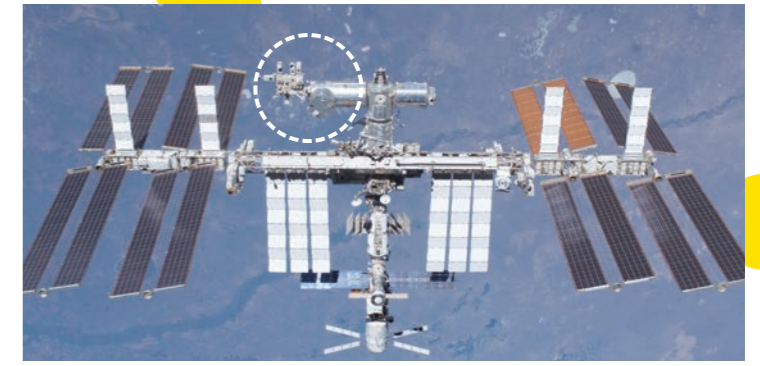
軌道上の国際宇宙ステーション。丸印部分が日本の実験棟「きぼう」(JAXA/NASA 提供)
