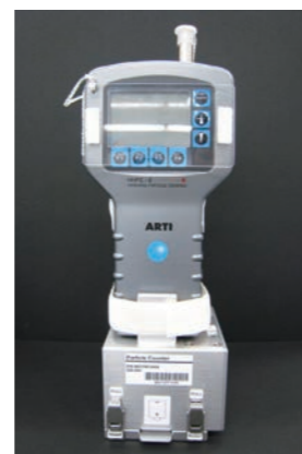
図1 (JAXA 提供) 改造したパーティクルカウンタ。下部の箱は改造で取りつけた乾電池ボックス。
