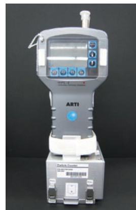
図1 (JAXA 提供) 改造したパーティクルカウンタ。下部の箱は改造で取りつけた乾電池ボックス。
