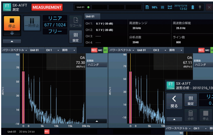
SX-A1FTによるFFT分析・波形収録 画面例
