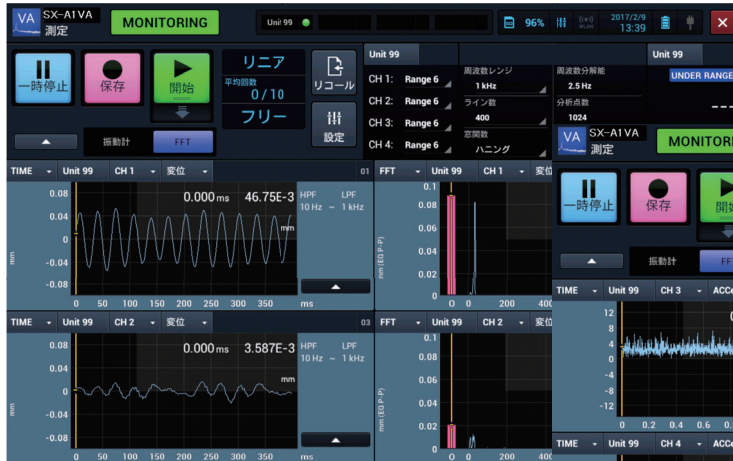
FFTモード 2チャンネル表示 (アンバランス)
