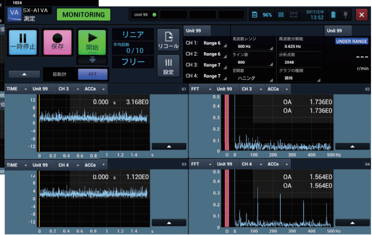
FFTモード 2チャンネル表示 (軸受異常)
