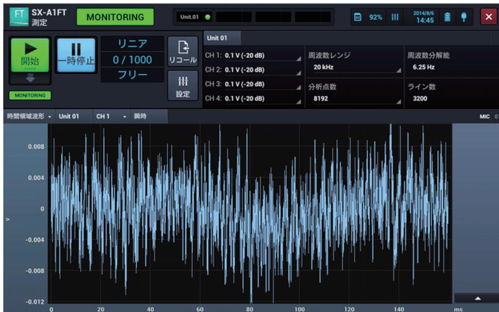
振動の多チャンネルFFT分析 時間波形画面例
