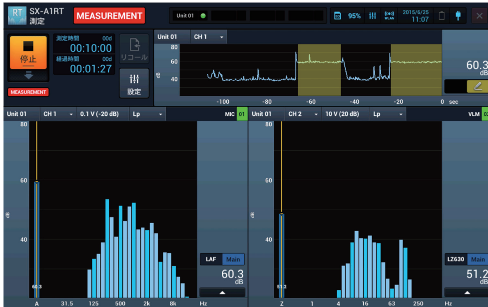
多チャンネルオクターブ分析 リアルタイム分析画面例 (SX-A1RTによるオートストア画面例)
